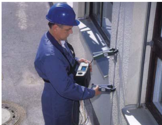
钳形接地电阻测试
